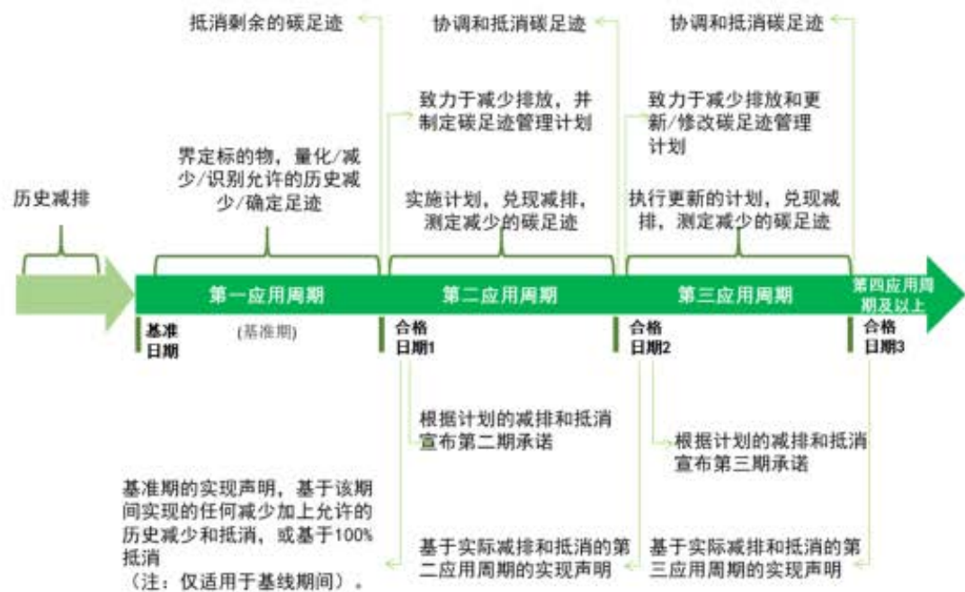
图 1-考虑到允许的基线应用周期例外，证明碳中和的循环过程示意图
